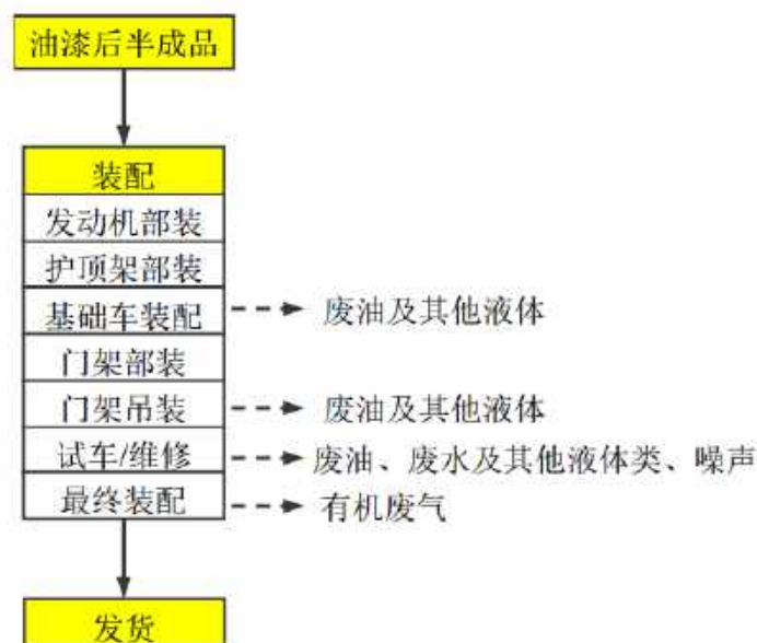
图 4.1-6 装配车间生产工艺流程及产排污环节
