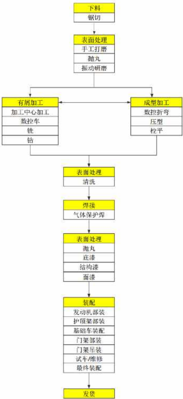
图 4.1-2 总体生产工艺流程图
