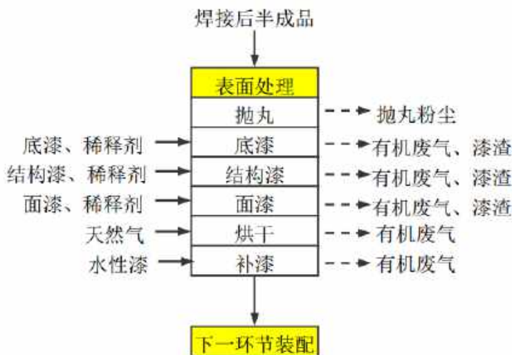
图 4.1-5 油漆车间生产工艺流程
